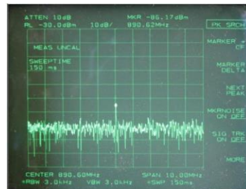
Porta fechada (890,60MHz): ISOLAÇÃO: -89,67dB
