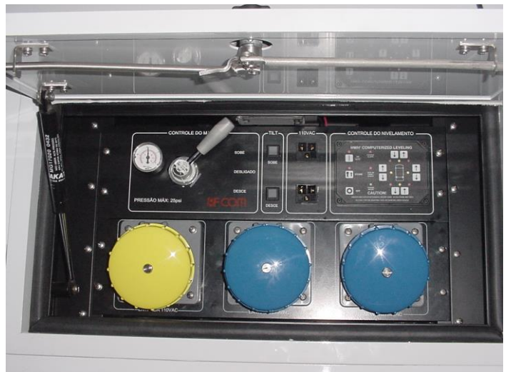
Painel de conexões de energia e comandos de nivelamento e mastro
