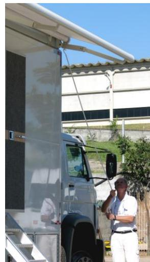
Acionamento manual ou automático (motorização disponível em 110 e 220Vac). O acionamento manual é feito com uma haste-manivela inclusa.
