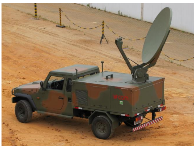
S-394 integrado a sistema de Comunicação via Satélite e Agrale Marruá AM 23 CC
