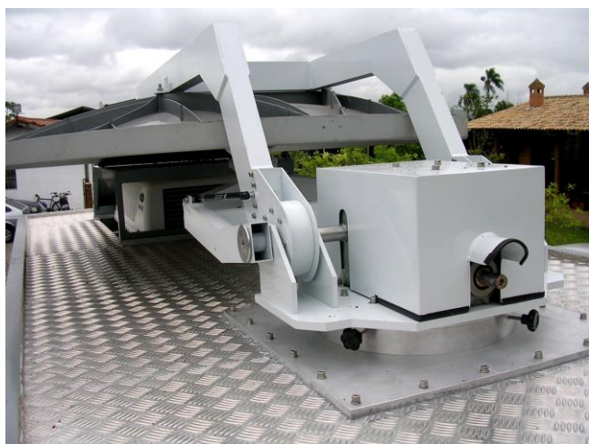
Sistema Manual RF COM: O ajuste de elevação é feito através de um redutor, com acionamento a manivela.
