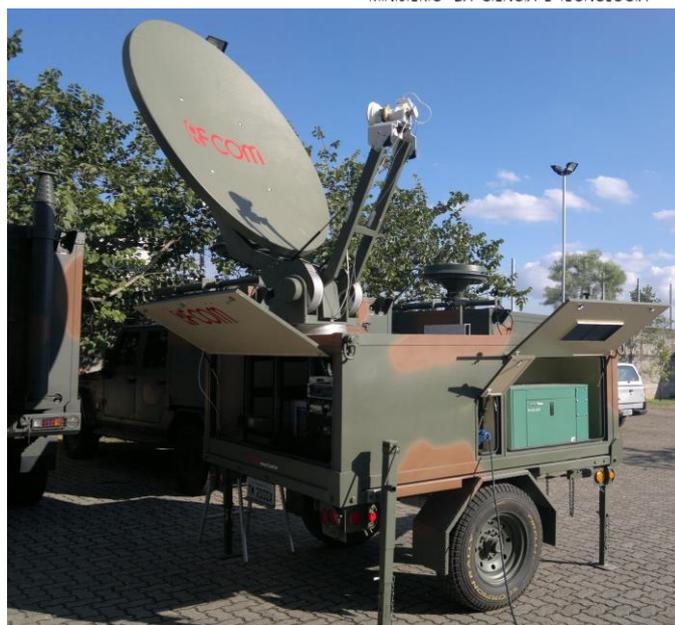
SAT-2000A integrado com posicionador e controlador automático, UPS e distribuição de energia, gerador diesel com tanque externo auxiliar, condicionador de ar e racks em semirreboque HMT-2000
