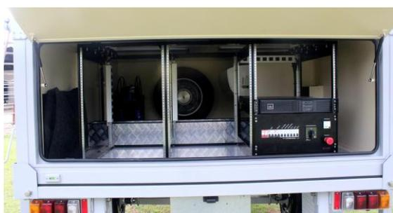
SAT-2000A integrado com posicionador manual, UPS e distribuição de energia, condicionador de ar e racks em semirreboque HMT-2000
