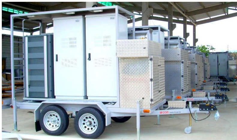
Sistema com mastro 18,3m e BTS Nokia 2G+3G
