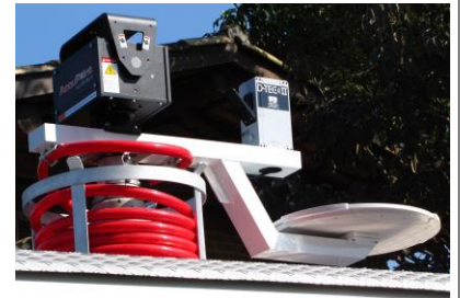
Suporte ("cabide") para AccuPoint/Antena de microondas, DTEC e antena "pizza"
