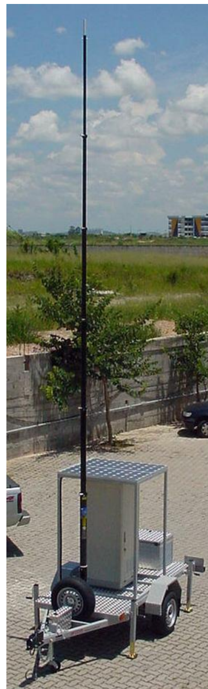
Sistema com mastro telescópico manual de 7,6m, dois módulos solares de 75W, gabinete e compartimento de gerador.
