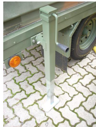
Macacos de nivelamento
