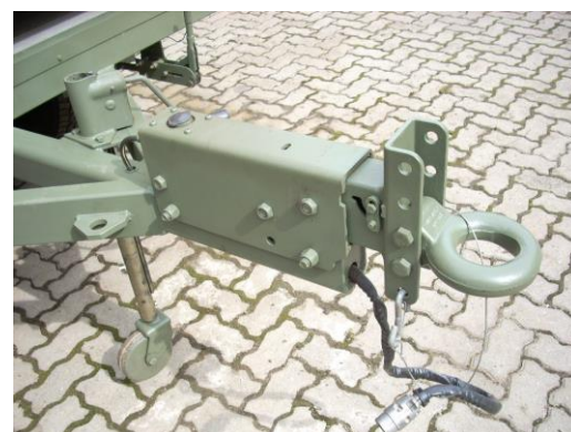
Sistema de freio inercial e engate do tipo olhal (pintle ring / lunette eye)
