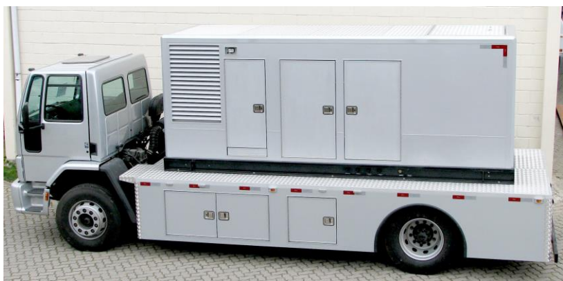
Sistema Gerador Móvel com Grupo Gerador de 200kVA
